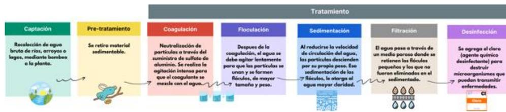
Figura 5. Proceso de potabilización.
