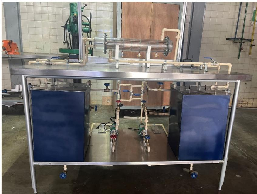
**Figura 17.** Intercambiador de calor tipo tubo y coraza.
