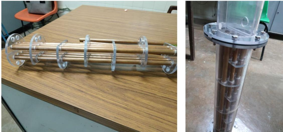
**Figura 12.** Ensamble de partes del intercambiador de calor.
