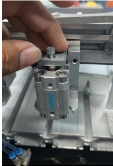
**Figura 13.** Cilindros neumáticos.
