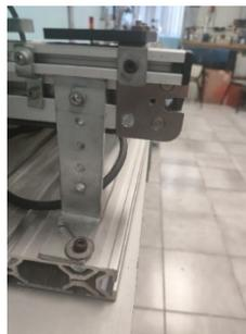
**Figura 10.** Solera en tipo L.
