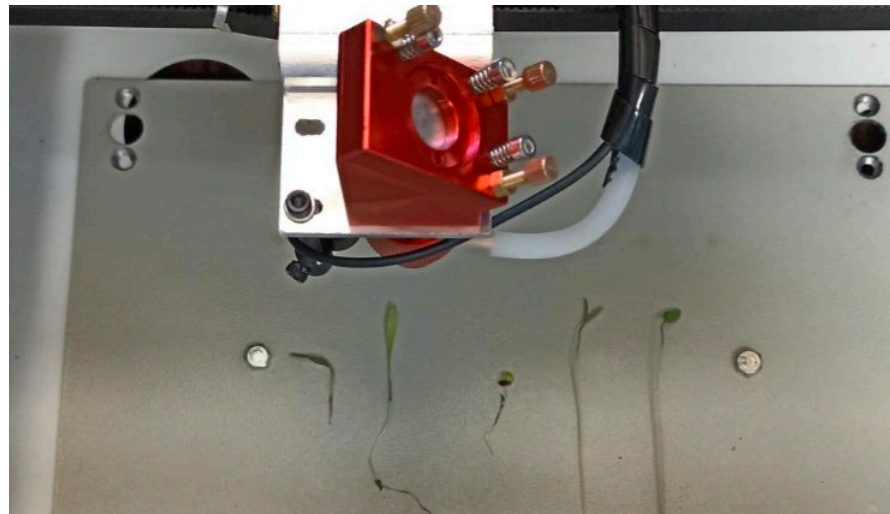
Figura 2. Arreglo experimental de la inhibición de arvenses con radiación láser.
