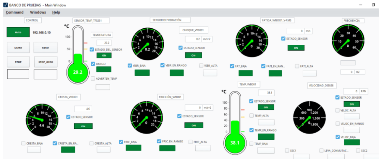
Figura 19. Interfaz de prueba de sensores de temperatura, vibración y velocidad (SCADA).
