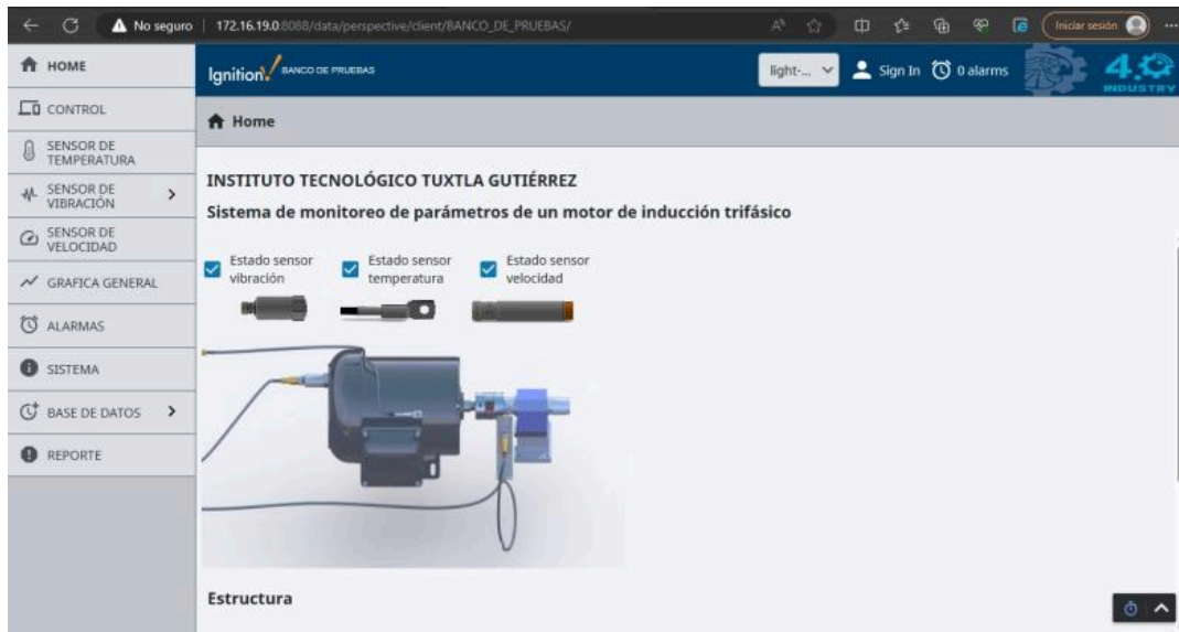
Figura 20. Interfaz SCADA en Ignition para el monitoreo de parámetros de un motor de inducción trifásico.
