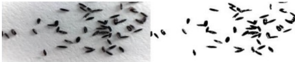
Figura 3. Pellón “B”. Segmentación con umbral fijo en valor de 80. Capturada la imagen con una cámara microscópica digital 1000x.
