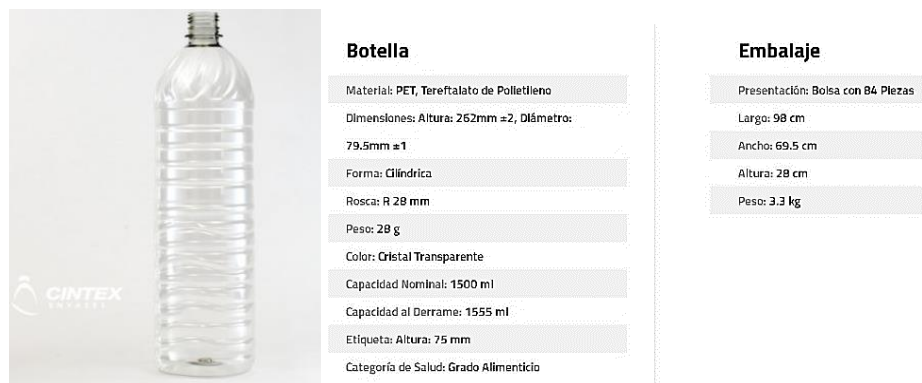
Figura 1. Características de una botella de plástico PET de 1500 ml (Cintex Envases, 2022).
