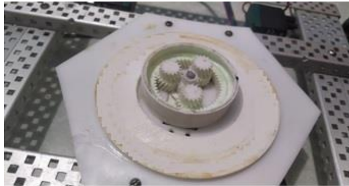
Figura 1. Montaje de la caja reductora de engranes helicoidales
