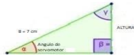
Figura 7. Altura de levantamiento de cada pata
