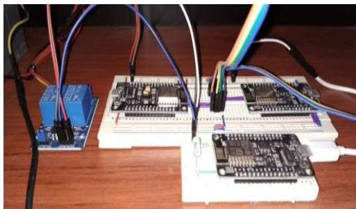
Figura 9. Circuito físico con NodeMCU implementado.
