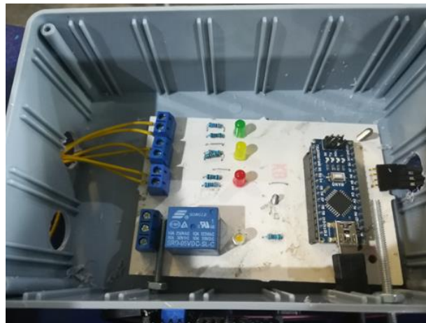
Figura 18. Placa electrónica con salida analógica y digital.
