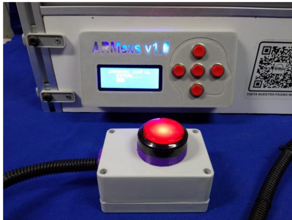
Figura 6. Paro de emergencia e interfaz humano-máquina.
