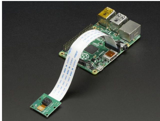
Figura 5. Módulo de cámara insertado en raspberry.
