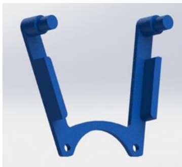
Figura 2. Herradura modelo para sujeción de polarizador.
