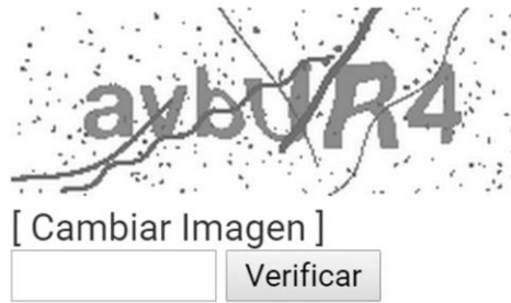
Figura 4. Método basado en OCR obtenido, muestra una imagen con caracteres alfanuméricos que deben ser ingresados en el campo textual para poder realizar la verificación del método, en este método es posible cambiar la imagen que se muestra.
